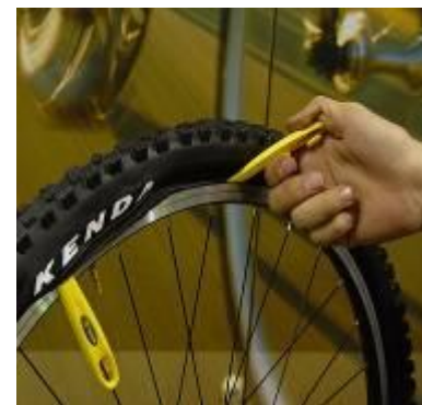
4. 取挖胎棒撬開第二開口
