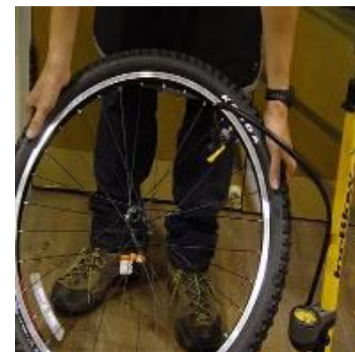
8. 完成充氣，檢視胎壁、氣嘴狀況
